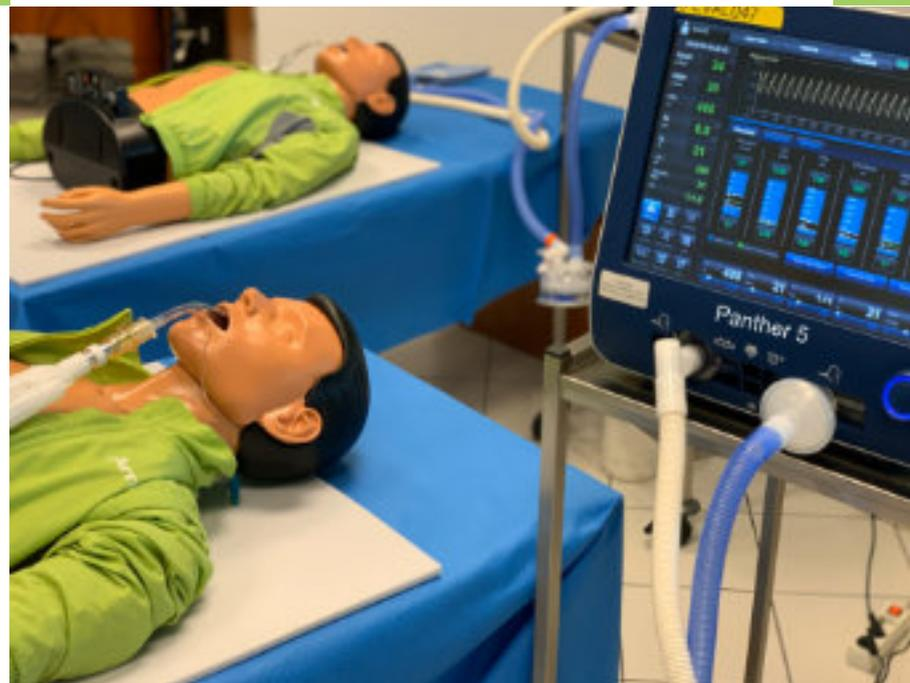
豹5呼吸机是一个ICU水平呼吸机，使用先进变量鼓风机技术和一个特别设计的流量控制阀。与其他基于鼓风机的通风机不同，这种设计提供了更清洁高流量气体的输送，对危急病人需要的极快响应和压力呼吸过程中非常快速和稳定的气流提供了保证。
