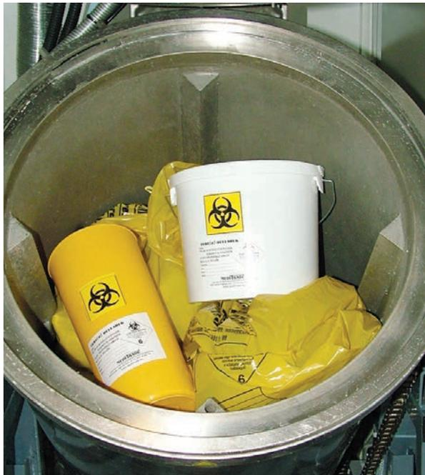
在5.7寸彩色触摸屏上,工作人员只需选择所需处理的废弃物菜单,按下按钮,安全处理舱门就会自动关闭,这时处理舱接受指令,自动旋转到工作位置,工作站就开始废弃物处理循环。
